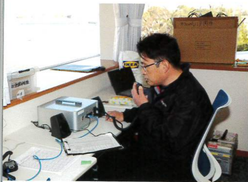
HQにも同様のシステム を構築。無線で通話す ると自動的にRoIPからス ターリンク経由で送信先 の音声通信を行う。
